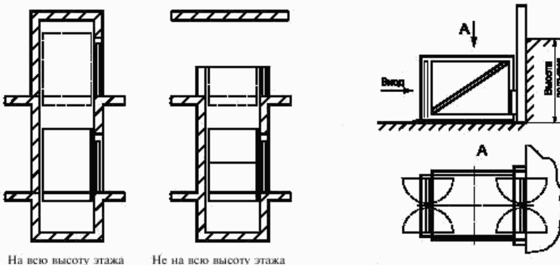
Рисунок 1 — Подъемная платформа в огражденной шахте
